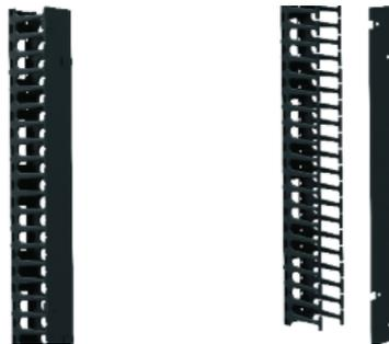
Para cubrir la zona junto al nivel de 19" en armarios EFB-Server de 800 mm de ancho Con escotaduras 3 x 19" 1U por lado para el paso de cables o el montaje de accesorios Sirve como cegado y control del flujo de aire Montaje sin herramientas a izquierda y derecha de los perfiles de 19" Material chapa de acero Acabado de pintura RAL7035, gris claro / RAL9005, negro azabache Volumen suministrado: 2 x panel incl. accesorios de montaje (sin herramientas)
