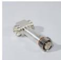
Divisor de Potencia Coaxial 2 vías 800W 870-960MHz 7/16 macho 7/16 hembra
