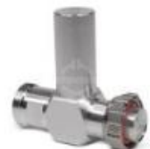
Protector Sobretensión 7/16 macho 7/16 hembra 3000W 380-512MHz cuarto de longitud de onda
