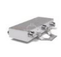
Combinador de Potencia Coaxial 3vías 7/16 hembra híbrido IP65 694- 2700MHz
