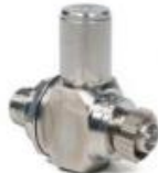
Protector Sobretensión 4.3-10 macho rosca 4.3-10 hembra 430-850W 694- 2700MHz híbrido
